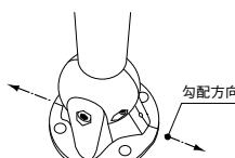
②マーキングした箇所に振動ドリル(φ 10mm)にて、深さ55mmの穴をあけ、付属のナイロンアンカーカーを挿入します。
