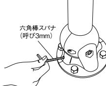
⑥ベースプレートを完全に固定し、カバーの切り欠き
