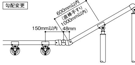
※フリージョイントを基点に平面図上の手すり角度が変わる場合は、両側150mm以内にブラケット(支柱)が必要です。
